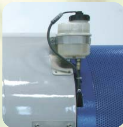
Serbatoio controllo livello olio riduttore. Reduction gear oil check reservoir. Réservoir de contrôle de l'huile du réducteur.
